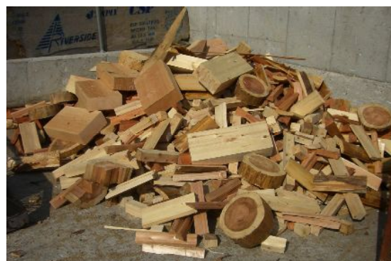
写真-18 原料の建設廃材
