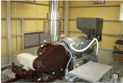
写真-13 小規模バイオマス発電 (スターリングエンジンとボイラ)
